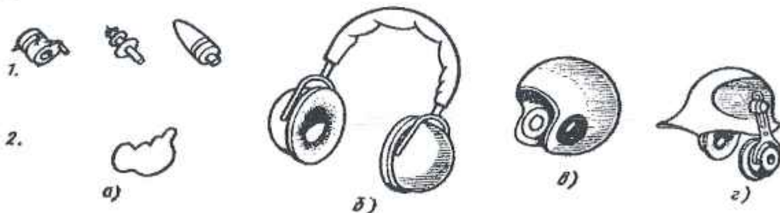
Hình 3. 1. Một số dụng cụ bảo hộ lao động chống ồn
